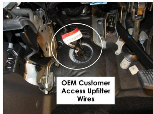
**Figure 3. Customer Access wires.**
