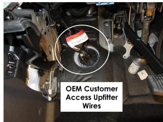
**Figure 3. Customer Access wires.**
